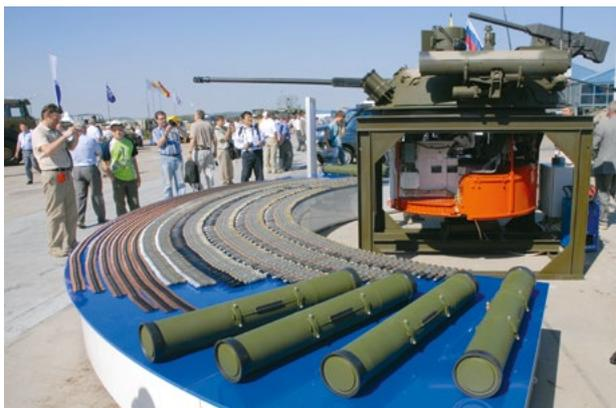
Боевой модуль «Бережок», разработанный в тульском КБ Приборостроения для модернизации БМП-2.
